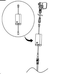
Verbinden Sie nun das Kupplungsstück des Streifens mit dem Kupplungsstück des Streifen Dimmers und verbinden Sie das Kupplungsstück des Streifen Dimmers mit dem Produktkabel-Connector.
