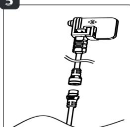
Verbinden Sie das Kupplungsstück der Stehlampe mit dem Anschluss des Produktkabels.
