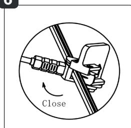
Setzen Sie den Produktstecker auf das 12-Volt-Hauptkabel und ziehen Sie den Stecker am Hauptkabel fest. Ihre Beleuchtung ist jetzt bereit für den Einsatz.
