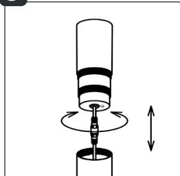
Verbinden Sie die Verkabelung des Gehäuses mit der der Lampe und schrauben Sie das Gehäuse auf die Lampe.
