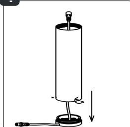
Option 1: Lösen Sie die Unterseite, indem Sie die 3 Inbusschrauben mit dem mitgelieferten Inbusschlüssel herausdrehen. Montieren Sie dann die Unterseite mit den 3 mitgelieferten Schrauben an der gewünschten Position. Schrauben Sie anschließend die Oberseite wieder auf die montierte Unterseite und sichern Sie sie mit den 3 Inbusschrauben.
