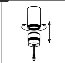
Schrauben Sie die Lampe fest an der Unterseite des Gehäuses.
