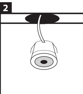
Bohren Sie die Löcher mit einem Sägemaß von 28 mm auf der gewünschten Position. Positionieren Sie zunächst die Kabel der LED Einbaustrahler an der gewünschten Stelle. Bringen Sie den LED Einbaustrahler an dem Lochsäge an. Bringen Sie den Einbaustrahler in Position, der Strahler klemmt sich mit den Federn ein.
