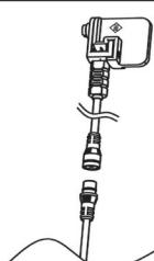
Verbinden Sie das Kupplungsstück der Wandleuchte (oder des 12-Volt-Verlängerungskabels) mit dem Anschluss des Produktkabels.
