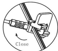
Setzen Sie nun das 12-Volt-Hauptkabel zwischen den Produktkabelanschluss und klicken Sie den Stecker sicher auf das Hauptkabel. Ihre Beleuchtung ist jetzt bereit für den Einsatz.
