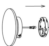
Lösen Sie die Schraube an der Oberseite des Aufbaurahmens und trennen Sie den Aufbaurahmen. Befestigen Sie den Aufbaurahmen mit den 4 mitgelieferten Schrauben an der Wand. Schrauben Sie dann die andere Seite des Aufbaurahmens auf die Wandleuchte und verbinden Sie die Kabel, die aus der Wand kommen, mit dem Kabel der Wandleuchte.
