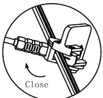
Legen Sie nun das 12-Volt-Hauptkabel zwischen den Produktkabel-Connector und klicken Sie den Connector auf das Hauptkabel. Ihre Beleuchtung ist jetzt bereit für den Einsatz.
