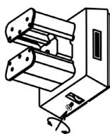
Befestigen Sie den Aufbaurahmen, indem Sie die Schraube an der Unterseite wieder festziehen.
