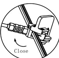
Setzen Sie den Produktstecker auf das 12-Volt-Hauptkabel und ziehen Sie den Stecker am Hauptkabel fest.
