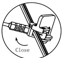
Befestigen Sie den Produkt-Connector am 12-Volt-Hauptkabel und drehen Sie den Connector fest auf das Hauptkabel.
