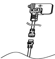
Verbinden Sie nun das Kupplungsstück des Bodeneinbaustrahler mit dem Produktkabel-Connector.
