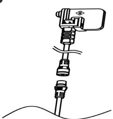
Verbinden Sie nun das Kupplungsstück des Bodeneinbaustrahler mit dem Produktkabel-Connector.
