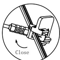
Legen Sie nun das 12-Volt-Hauptkabel zwischen den Produktkabel-Connector und klicken Sie den Connector auf das Hauptkabel. Ihre Beleuchtung ist jetzt bereit für den Einsatz.
